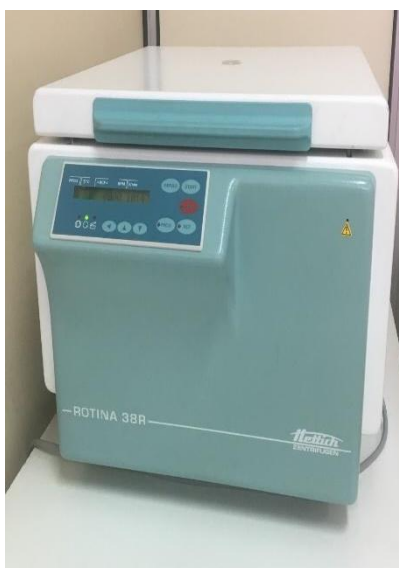
Figura 15. Centrifuga refrigerada utilizada para recuperar los extractos de lúpulo de los correspondientes marcos (GQBMRNP - CRIDECIT, FCNyCS, UNPSJB, foto: Carmita Lucía Lojano Gutierrez).
