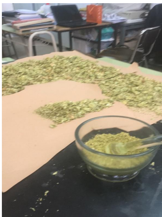
Figura 14. Trituración de inflorescencias secas de lúpulo en mortero (GQBMRNP - CRIDECIT, FCNyCS, UNPSJB, Foto de Lucía Gutierrez).
